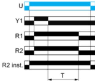
**Función Ct: relé con retardo a la desactivación con señal de control y con control de suma/pausa**
