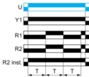
**Función Dt: relé de intermitencia simétrico (arranque en reposo) y con control de suma/pausa**
