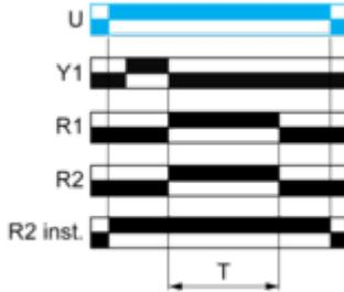
**Función Wt: temporización a la activación con señal de control desactivada y con control de suma/pausa**
