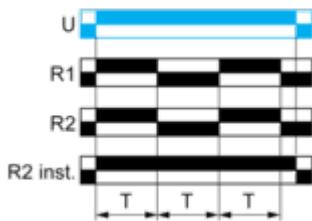
**Función Dit: relé de intermitencia simétrico (arranque en trabajo) con control de suma/pausa**
